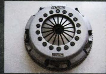
圧倒的な軽さを実現したカーボンディスクの効果によって、素早いシフト操作を可能にしてくれるのがカーボンクラッチだ。クラッチのミートがマイルドなため、半クラッチの操作がしやすく街乗りで扱いやすいのはもちろん、変速時のシンクロへの負担を減らす効果も期待できる。カバー圧着力を1600kgに設定することで、シングルながら450psにまで対応する容量を確保している
