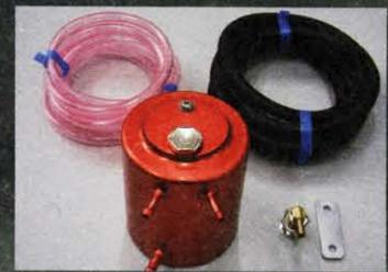
S15のウイークポイントとして挙げられることが多い6MTだが、トラブルの最大の要因と考えられるのが、ミッションオイルの容量不足だ。そこで、アームズではミッションオイルの容量をノーマルの1.8ℓから3.0ℓに増やすことができるキャッチタンクを開発した。油量が増えることで、油温上昇が抑えられ、シンクロへのダメージを軽減することができる
