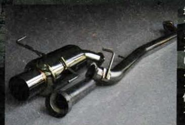
地上高が低くなりがちな従来の社外マフラーではマフラーをヒットしやすく、その衝撃でエキマニにダメージがおよぶというトラブルがしばしば見られた。そのため、アームズでは、マフラーをできるだけプロアに近づけるようにレイアウトし、最低地上高を確保できるものをオリジナルで開発。最低地上高の確保だけでなく、排気効率やカン高いエキゾーストサウンドにもこだわった逸品だ
