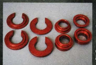
リアメンバーとボディの接合部にセットされるブッシュの剛性が低く、ハードな走行ではメンバー自体が動いてしまいやすいシルビア系のリア・マルチリンクでは、このメンバーブッシュを強化するカラーの装着が定番となっている。アームズでは、カラーを装着してもロールセンター高が変化しないよう、S15のメンバー形状に合わせて設計したS15専用品をリリースした
