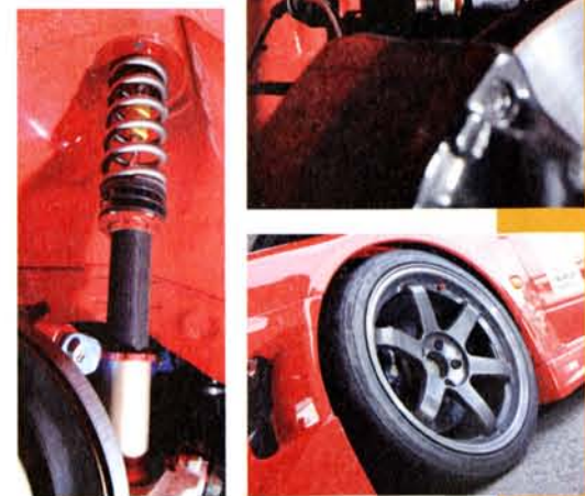
スプリングレートをF:11kg/mm R:12kg/mmに変更
