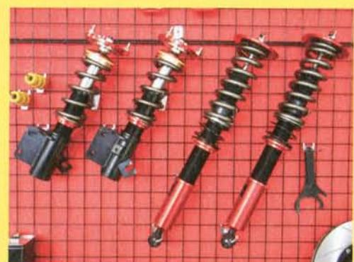
ストリート用は低バネレートだがロールがバンブラーによってじんわり止まってくれるためにコントロールしやすい。減衰力調整も最弱から最強まできちんと使いわけが可能。6~12 kg/mmまでのレートに対応
