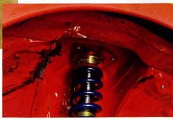
車高ダウンによってタイヤがよりボディに近いところで動くようになるが、フロントフェンダー内の上部をカットすることで対応。右フェンダー内を通るハーネスもエンジンルーム内に引き直して干渉を避ける
