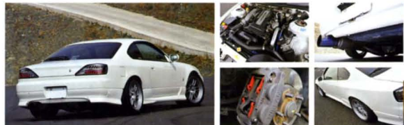
■写真左上:現実的な仕様がワークアップを目指すというエンジン。■右上:オートプロデュース・ボスのチタムワラーはメインφ90mm■右下:パッドはアルドで削削。■255/40R17の21インチSPCを収めるワイドフエンダー
