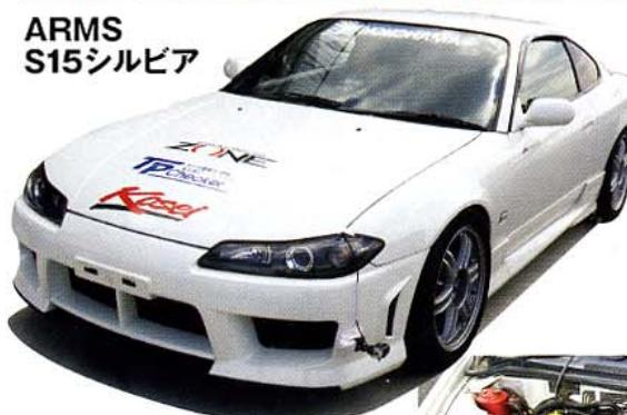
テスト車両のS15は、シリビアのチューニングを得意とする長野県のプロショップ。アームズのデモカーだ。エンジンは吸排気チューンのみのライトチューンながら、足まわりはアベックスN1ダンパーをベースに、木下みつひろ選手と共同でセッティングを施したオリジナルのサスキットが装着されるほか、ブッシュ類やメンバーカラーなど、シリビアを知り尽くしたアームズらしい細部にまでこだわった完成度の高い仕上がりがポイントとなる。
