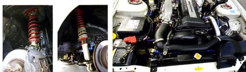
テスト車両は、定番のFRターボ車、S15シルビアで足まわりを中心に手を加えたライトチューン車だ。テスト用のタイヤは、すべて255/40R17サイズで、テスト条件を統一すべく装着ホイールもすべてコニセイのK-1 レーシングで行った。また、今回から新たな試みとして各ホイールにドライビング中にも空気圧の確認が可能なTP チェッカーアームズで確認してほしい）。ちなみに内圧の設定は、各タイヤとも200kPaからスタート。各タイヤのインプレッションとともに、走行後の空気圧とタイヤ表面温度の測定結果も紹介しているので、インプレッションと合わせてその数値をチエックしてもらうと、タイヤの特性を理解するのに役立つハズだ。
