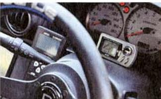
インテリアはシンプルにまとめられている。ステアリングコラム上に設置されたブーストコントローラーはブリッツ、その奥にはパワーFCのコマンドが確認できる
