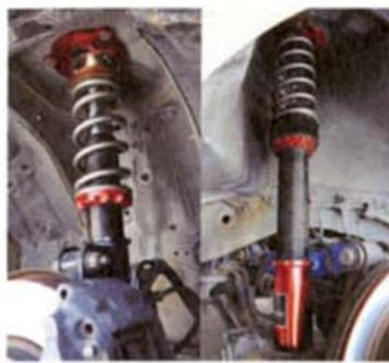
開発段階では前後10kg/mmのスプリングにもなったというが、街乗りを意識した結果フロント7kg/mm、リア6kg/mmに落ち着いた新しい車高調。価格は19万4250円
