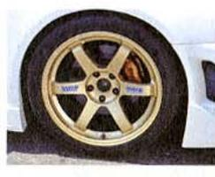
ブーストアップ程度のパワーであれば純正キャリアプラススポーツパッドでカバーできるという判断だが、400psにはGT-R純正ブレムボを移植して対応している
