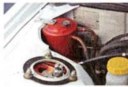
ストラットタワーの奥に見えるのが山田プロも絶賛するミッションオイルキャッチタンク。なおキャンバーは3.5度、フロント・トーゼロ、リア・トーインのアライメントにセットする
