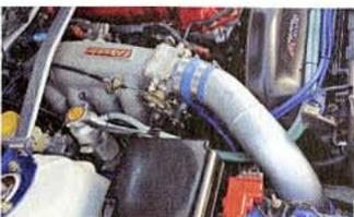
吸気系でのハイライトは、バルサアの70mm大径スロットルを流用している点。パワー重視のエンジンキャラクターを意識したチューニングとなっているといえそう
