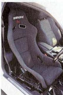
ブリッドと共同でオリジナルスベックのバケットシートを開発中。サイトサポートの形状を工夫することでロングドライブでの疲労を減らし、サーキットでのホールド性と両立を狙っている
