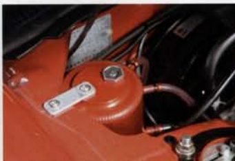
ミッションオイルキャッチタンク。S15の6速やニスモの6速ミッションは、根本的に油量が不足気味で、それを解消するのに効果的。パワーアップ時のミッション保護にも有効。
