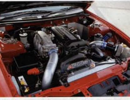
エンジンはHKSのキットを用いて2.2化を図り、タービンをHKSのGT30に換装して、最大出力500psを実現している。サクシヨンプイプはオリジナル品で、「よりストレートであること」を追求したのが特徴。
