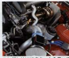
エンジンはHKSのキットを用いて2.2化を図り、タービンをHKSのGT30に換装して、最大出力500psを実現している。サクシヨンプイプはオリジナル品で、「よりストレートであること」を追求したのが特徴。
