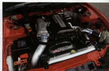
2・2ℓにボアアップされたエンジンに、ピックアップの向上を狙い、コンパクトなタービンを組み合わせる。その結果、低い回転域からでも厚いトルクが発生し、クルマを力強く引っ張ってくれる。
